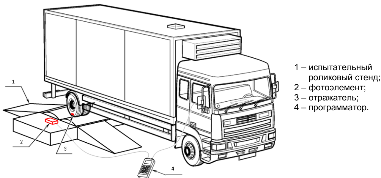
Рисунок 26. Определение параметра w на роликовом стенде
